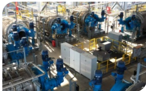
国内最大高密度聚乙烯（HDPE）蒸汽管干燥机
